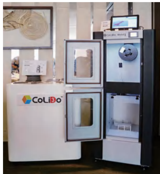
天威自主研發的AMSS 金屬3D印表機
